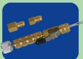
91498 Kit démonte/monte obus Le kit 91498 est le seul outil démonte/monte obus incorporant un écrou de sécurité. Celui-ci permet au technicien d'engager le noyau de vanne sans devoir combattre la Haute Pression. Ce kit comprend le filetage 5/16 ainsi qu'un raccord 1/4 SAE. Emballé en boîte en plastique rigide.
