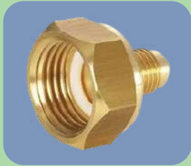
13390-LH Réduction 1/4" SAE. Pas à gauche pour fluide inflammable
