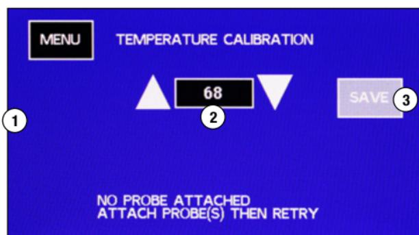
1. Brancher un thermocouple de type K qui doit être étaloné. Les mentions HIGH SIDE (Haute pression) et/ou LOW SIDE (Basse pression) s'affichent lorsqu'un capteur est branché sur le manifold dans ces positions. Les capteurs doivent être branchés avant de passer à cet écran.
